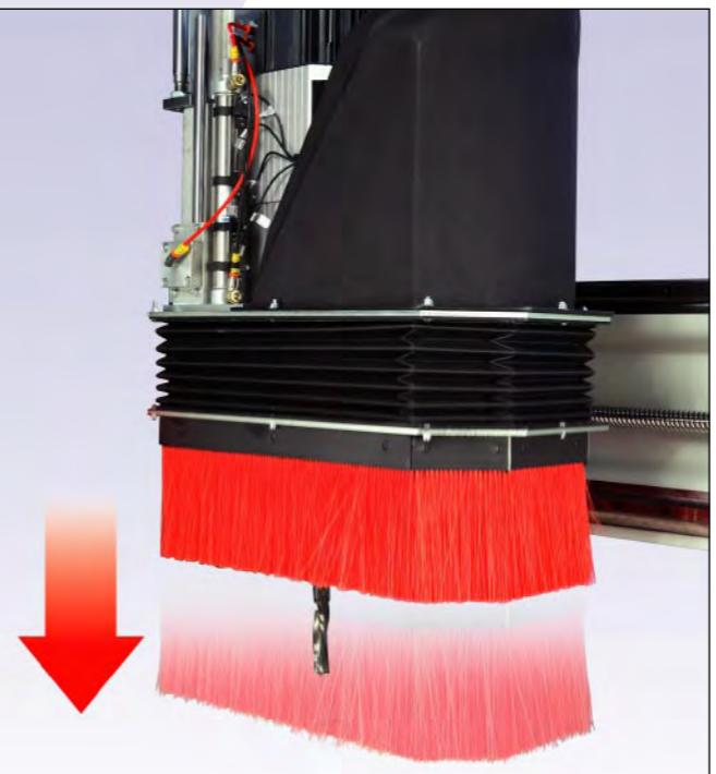
Cuffia di aspirazione con altezza variabile (std) e deflettore di trucioli sull'utensile (opt) gestiti da CN per l'ottimizzazione dell'aspirazione.
