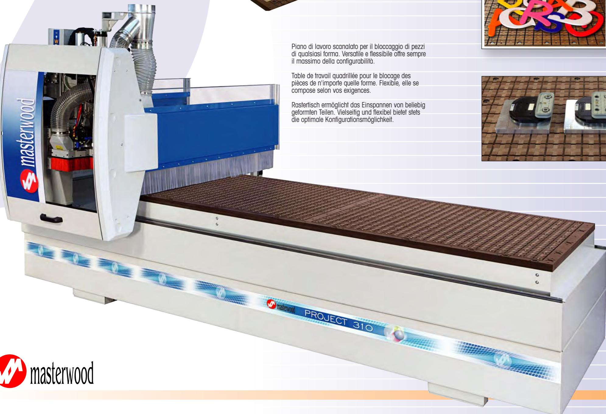
Piano di lavoro scanalato per il bloccaggio di pezzi di qualsiasi forma. Versatile e flessibile offre sempre il massimo della configurabilità.
