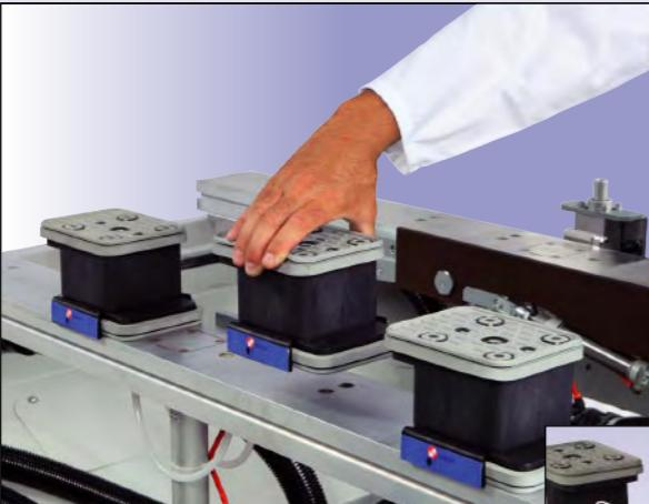
Il sistema di depressione permette il posizionamento rapido dei dispositivi di bloccaggio riducendo notevolmente i tempi per la configurazione del piano di lavoro.
