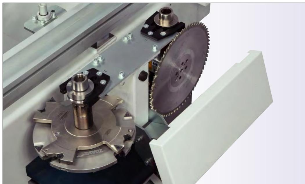
Magazzino per cambio utensile automatico a bordo carro e magazzino a bordo basamento per alloggiare utensili di grandi dimensioni.
