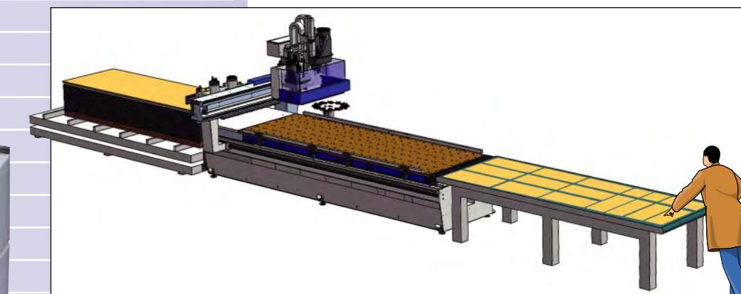
Sistema di carico e scarico automatico con piattaforma elevatrice idraulica e tappeto motorizzato.
