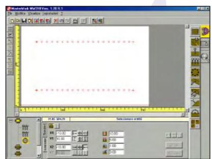
Programmazione grafica di foratura, fresatura, taglio e ottimizzazione del ciclo di foratura.
