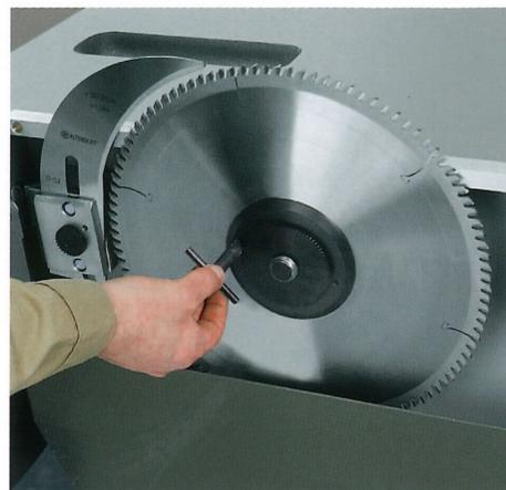
Changement de lame de scie plus rapide et plus confortable grâce au système de serrage rapide.
