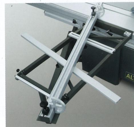
Guide d'onglet transversal : pour une coupe précise d'angles et d'onglets en une fonction. Plage de tronçonnage : 95 – 3200 mm. Réglage progressif de l'angle d'inclinaison de 0 à 49°.
