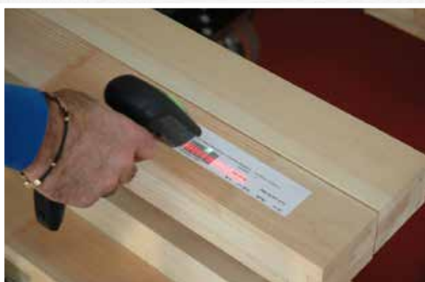
Lettura del codice a barre sul grezzo nel magazzino Bar code reading on raw material in warehouse Lecture du code - barres sur les pièces brutes de 4 faces Strichkode-Lesung auf den Rohteilen
