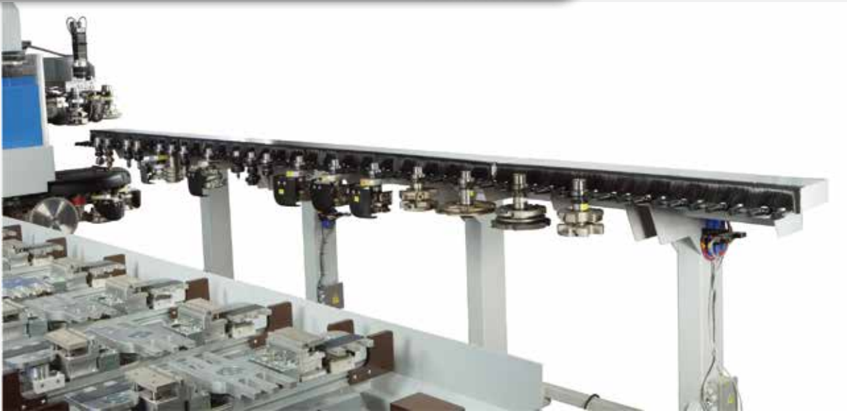
Magazzino utensili circolare a 16 posizioni posteriore a bordo carro. Magazzino utensili circolare a 10 posizioni posizionato a fianco dell'elettromandrino. Magazzino utensili lineare a 12 (24 opt.) posizioni.
